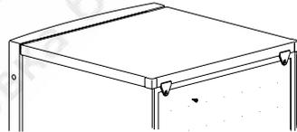
2. Для освобождения верхней крышки сдвиньте ее вперед. После этого сдвиньте небольшую пластинку слева направо. Затем уберите верхнюю крышку в безопасное место, чтобы не поцарапать.
