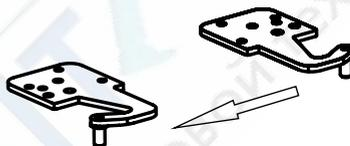
15. Установите дверцу на нижнюю петлю. Приложив дверцу к корпусу и убедившись, что она удерживается на нем, установите верхнюю петлю в отверстие для петли. Правая и левая стороны дверцы должны располагаться по одной линии со сторонами корпуса. Затем надежно закрепите верхнюю петлю.
