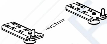
11. Вывинтите крепежные винты нижней петли и снимите нижнюю петлю вместе с ножкой.
