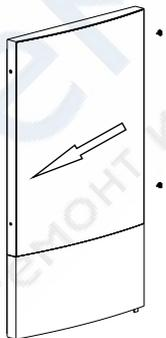
6. Вывинтите винты петли и снимите петлю, а затем поднимите дверцу и положите ее на мягкую поверхность, чтобы не поцарапать. Поместите петлю и винты в безопасное место.
